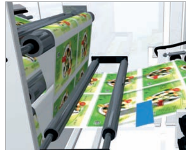
Failure flagging tesa® 4104
